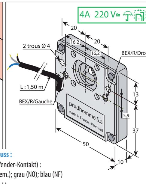
Das BEX hat einen Wasserdichten 4A / 220 V Wender-Kontakt. Dieser Kontakt wird mit dem Dreikantschlüssel actioniert sobald dieser gedreht wird um die Tür zu öffnen. Dieser Kontakt freigegeben kann er zum Beispiel einen Alarm oder die Beleuchtung des Fahrtschachts actionieren. Sobald der Schlüssel nicht mehr benützt wird wird der Kontakt unterbrochen.
